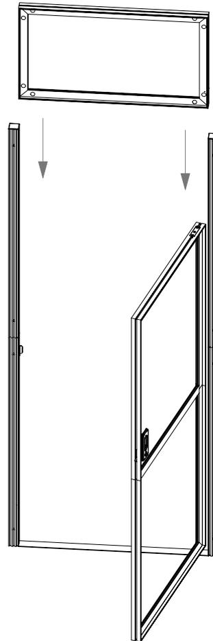
3 Verrouiller l'imposte aux mâts à l'aide des vis (ST231) et attaches rapides (FX268) fournies
