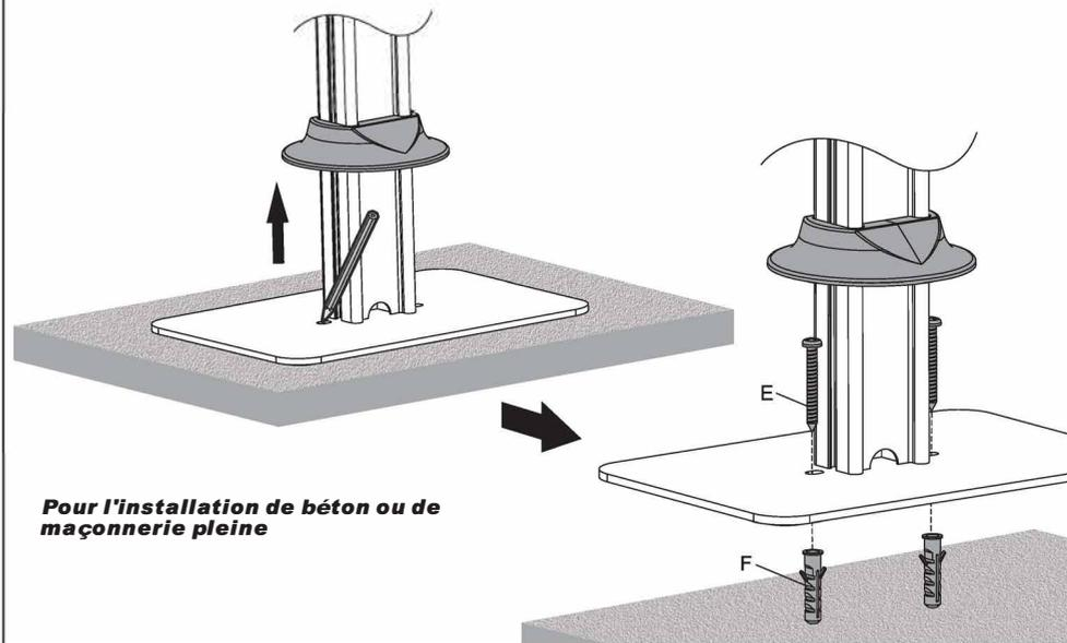
**Pour l'installation de béton ou de maçonnerie pleine**
