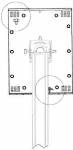
Avant de verrouiller le boîtier, vérifiez que les caméras sont visibles à travers la fente, comme illustré.
