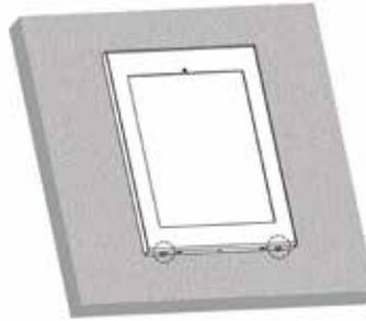
Avant de verrouiller le boîtier, vérifiez que les caméras sont visibles à travers la fente, comme illustré.
